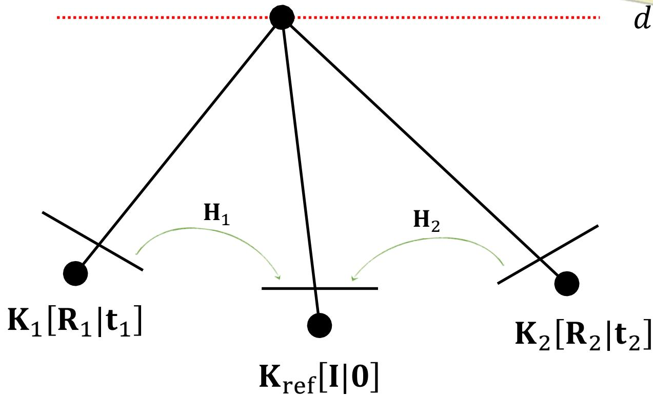
深度 $d$ 平面的单应变换:  $H_k = K_k \left( R_k^T + \frac{R_k^T t_k n^T}{d} \right) K_{\text{ref}}^{-1}$
